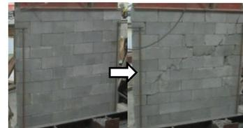
Gambar 4. Hasil uji dinding BTPTP
